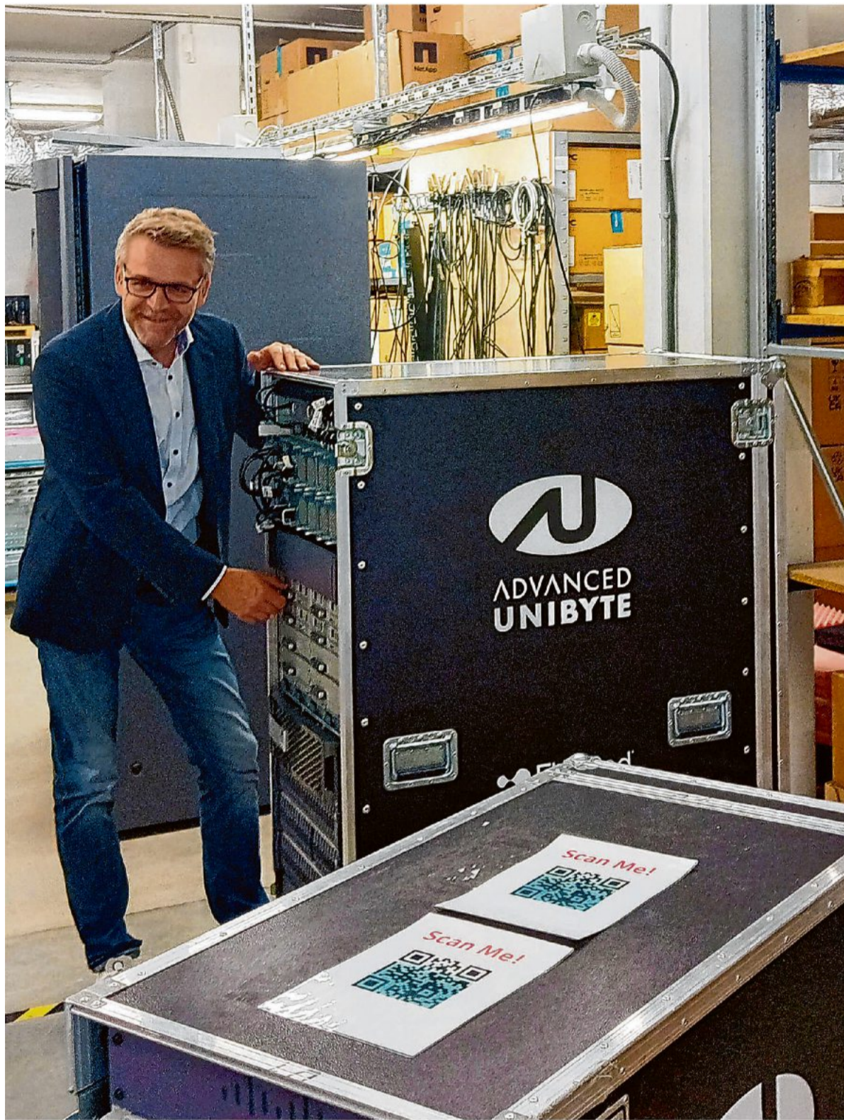
Advanced Unibyte-Gründer und -Inhaber Sandro Walker mit einem mobilen Rechenzentrum, das zum Einsatz kommt, wenn ein Unternehmen Ziel eines Hackerangriffs geworden ist. Foto: Ralph Bausinger
