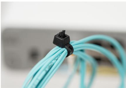
Beschädigung durch zu festen Kabelbinder
