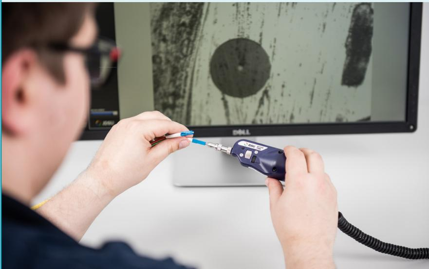
Analyse eines verunreinigten Glasfaserkabels unter dem Mikroskop
